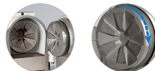
2개 Disk 사이에 발생하는 shearing 이용한 분쇄
